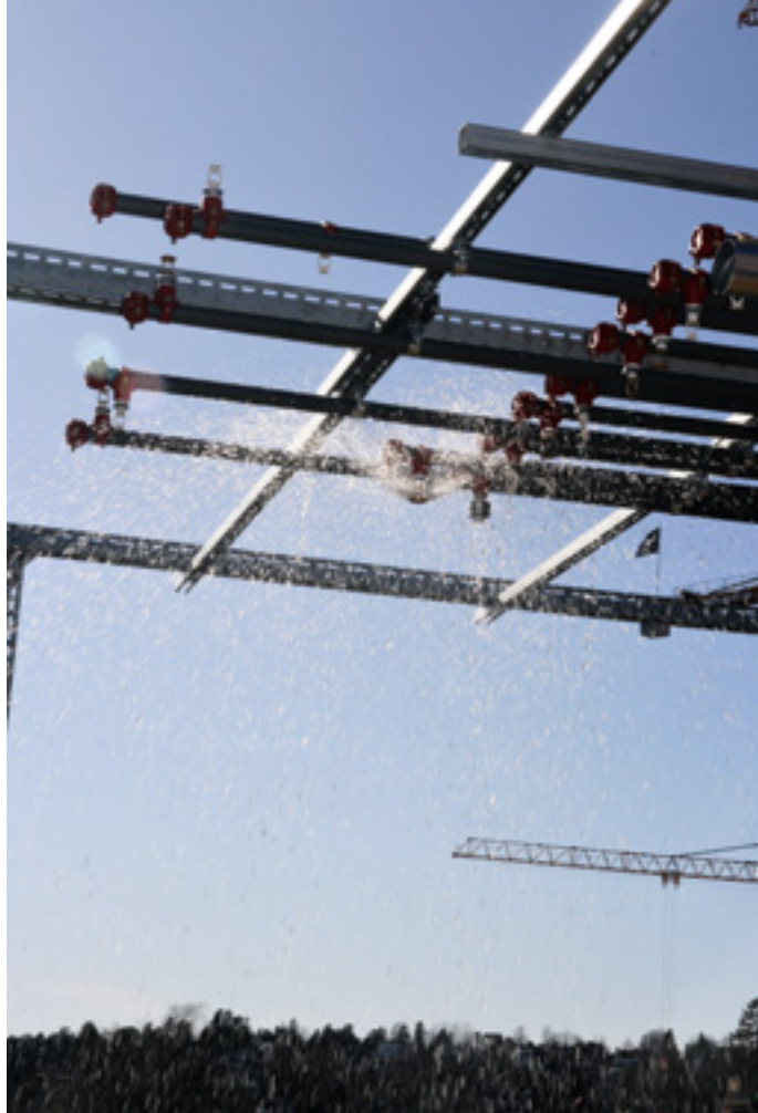
Hva skjer med spredemønsteret om man monterer sprinklerhodet feil vei?
